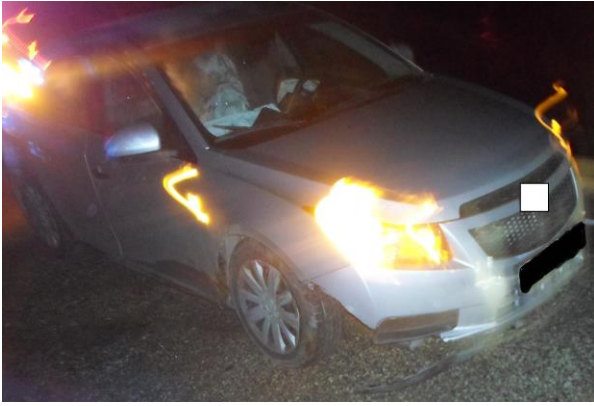
Şekil 1. Araç içerisinde açılan hava yastıkları ve sağ ön tampondaki minimal hasar
